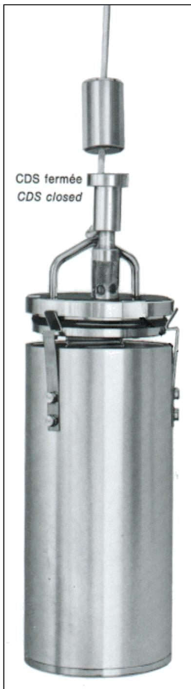
Cet échantillonneur, permet de prélever directement dans le flacon (*bouteille en verre, flacon plastique, ou boîte métallique pour les produits chauds comme le bitume*) destiné à recevoir l'échantillon.
