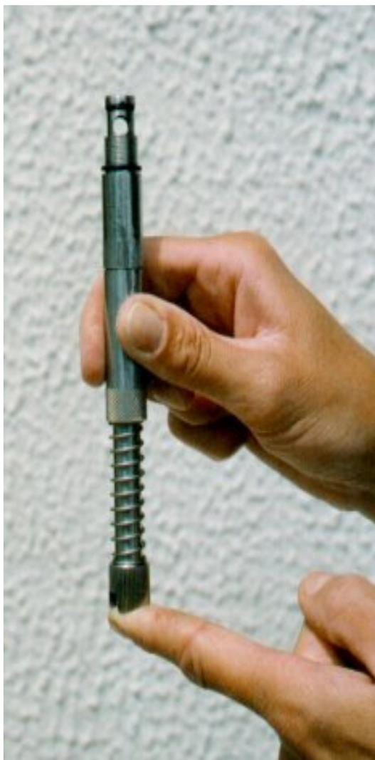
Le Suceur de Fond, accouplé à l'Echantillonneur Ponctuel, permet le prélèvement d'un litre de produit se trouvant au fond d'une cuve de façon simple et rapide.
